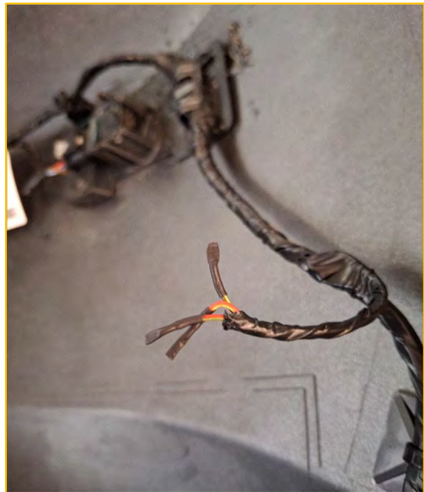
Bild 3: Kabelenden im Nassbereich wasserdicht abisoliert
