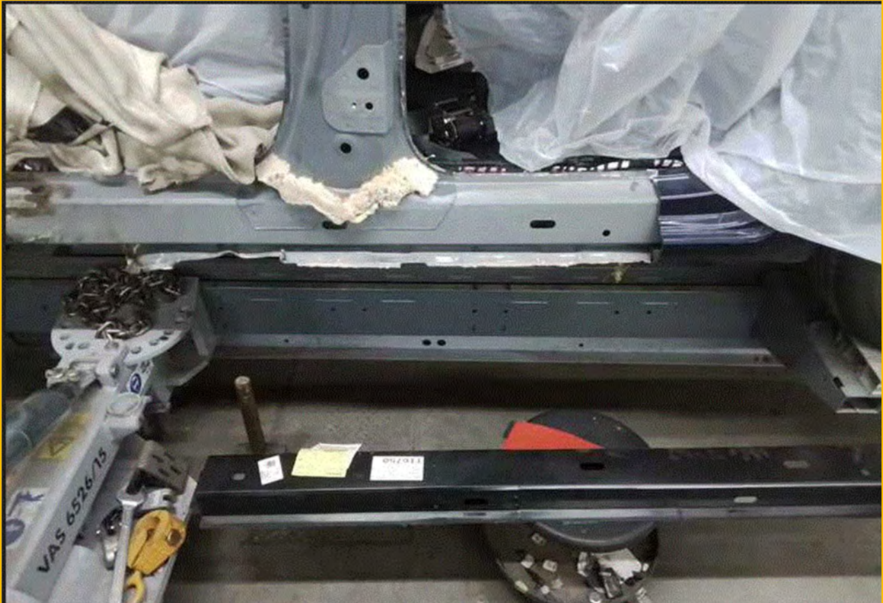
Bild 16: Werkstattbild freigelegter Unterholm außen, mit Anbindung Verstärkung Unterholm an Verstärkung B-Säule sowie Neuteil-Verstärkung Unterholm.
