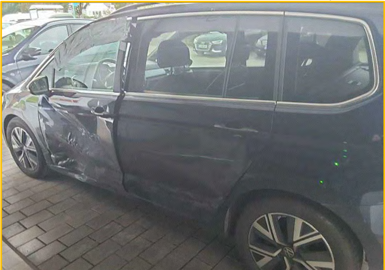
Bild 1: Werkstattfoto, VW Touran Unfallschaden linke Seite
