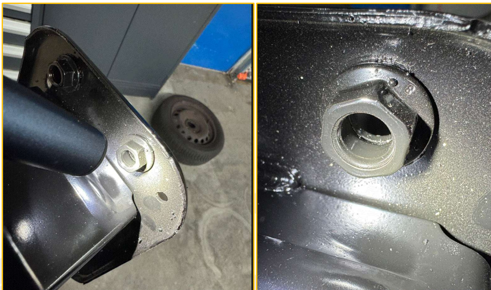
Bild 4+5 Ansicht Aufschweißmuttern ohne Gewinde, Querträger/Traversen links und rechts
