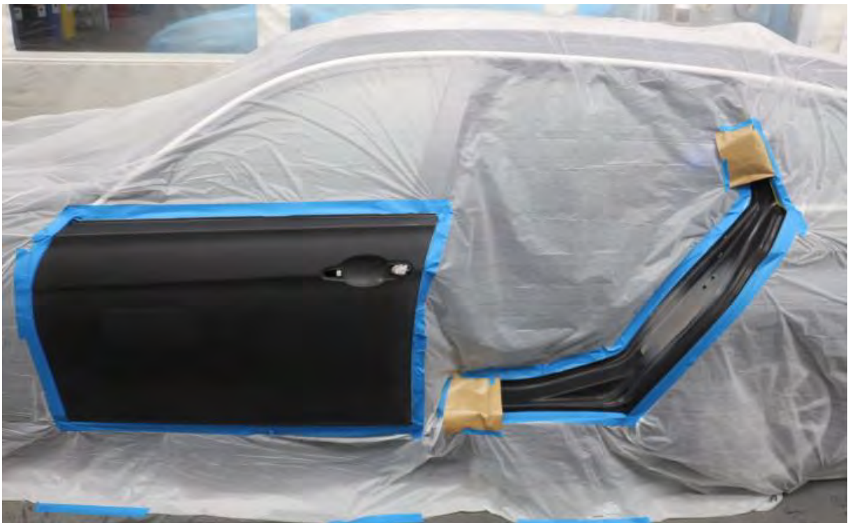
Abbildung 4: Zur Decklackierung vorbereitetes Fahrzeug mit Reparaturlackierung des hinteren Kniestücks innen durch das auslaufende Lackiervorgang am unteren Einstiegschweller und entlang der inneren C-Säule.
