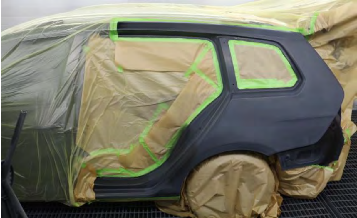
Abbildung 3: Zur Decklackierung vorbereitetes Fahrzeug mit Reparaturlackierung der hinteren Seitenwand und auslaufendem Lackiervorgang am Dachholm und im Bereich des hinteren Einstiegschwellers.
